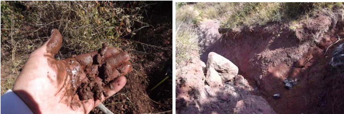
Figura 34. Prueba de textura del suelo y erosión hídrica
