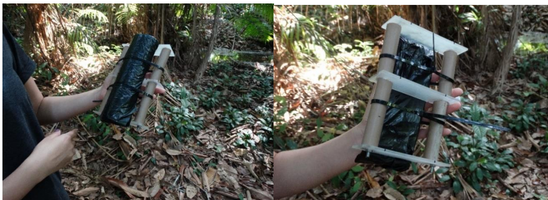
Figura. 7. Amostrador de perifíton confeccionado para o estudo.
