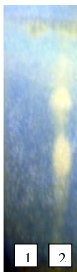
Figura 6. Cromatograma da resina glicosídica obtida. 1- Extrato Clorofórmico e 2- Extrato Metanólico.
